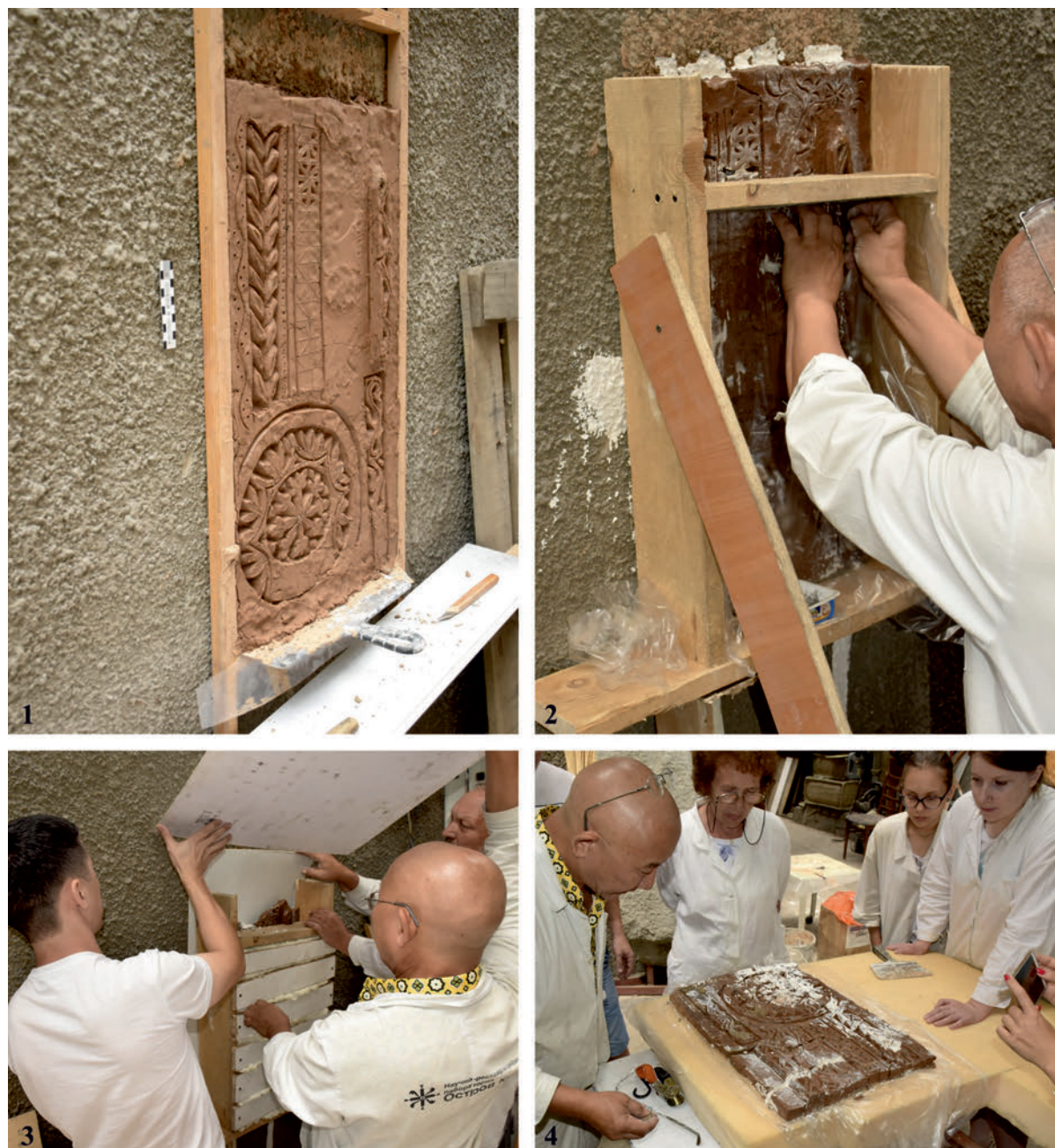
Рис. 4. Разработка метода снятия в лаборатории: 1 – образец из глины с резьбой, имитирующий древние панели; 2, 3 – подготовка к снятию (варианты); 4 – обсуждение результатов снятия. Фото из архива лаборатории «Остров Крым»
