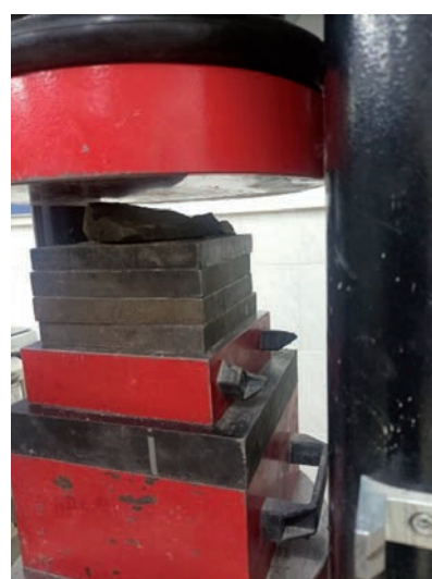
Рис. 3. А – этапы отбора образцов на геоинженерные испытания; В – проведение испытаний на водонепроницаемость; С – процесс проведения испытания на прочность песчаников.
